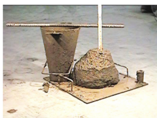
Consistenza S3 slump 100 - 150 mm
