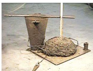
Consistenza S4 slump 160 - 210 mm
