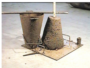
Consistenza S1 slump 10 - 40 mm
