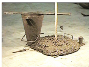
Consistenza S5 slump > 220 mm
